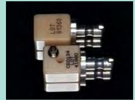
Abb. 2: Vergleich zweier Blöcke aus Hybridkeramik (Vita Enamic): Auf der 6-Uhr-Position ist in der Vorbohrung für den Schraubenkanal die Schnittstelle für die TiBase von Dentsply Sirona zu erkennen.
